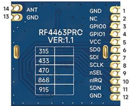
注：芯片的 GPIO2 和 GPIO3 管脚，模块内部已直连天线开关。GPIO2 控制接收，GPIO3 控制发射。
